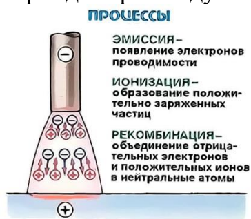
Рисунок 1. Процесс ионизации в период горения дуги.
