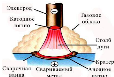
Рисунок 2. Формирование сварочной дуги
